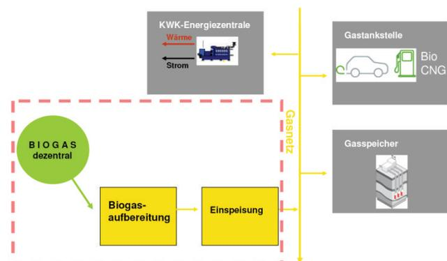
Biogas entsteht als Stoffwechselprodukt von Methanbakterien bei der Zersetzung organischer Stoffe unter Ausschluss von Sauerstoff. Diese Bakterien zersetzen bei einer bestimmten Temperatur feuchte Biomasse, wobei das Biogas als Abfallprodukt anfällt.
